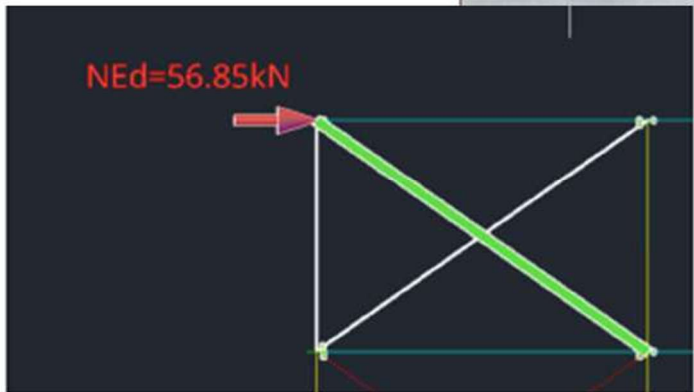
Σύνδεσμος Χιαστί: Έλεγχος σε ΟΚΑ με συνδυασμό Άνεμος (δυσμενής) και Μόνιμα (ευμενής)
