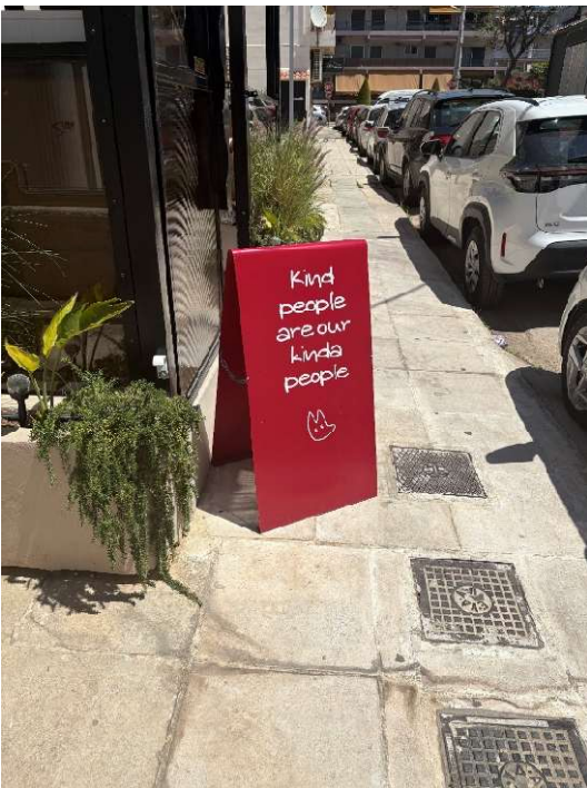
Εικόνα 4.11 «Εμπόδιο επί της ζώνης όδευσης, που επηρεάζει την πορεία των πεζών»
