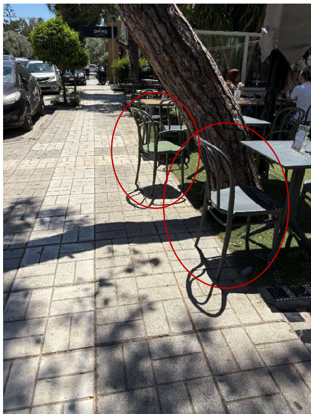
Εικόνα 4.25 «Εμπόδιο επί της ζώνης όδευσης, που επηρεάζει την πορεία των πεζών»
