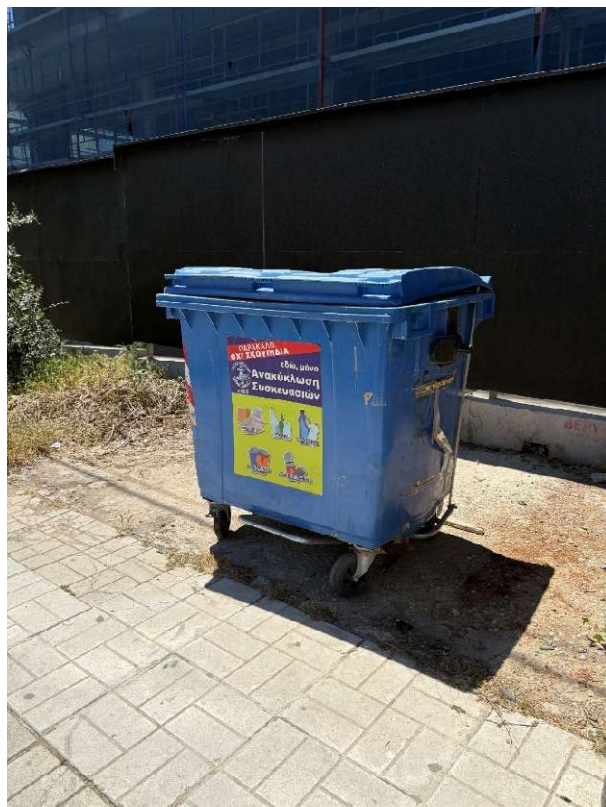
Εικόνα 4.30 «Εμπόδιο επί της ζώνης όδευσης, που επηρεάζει την πορεία των πεζών»
